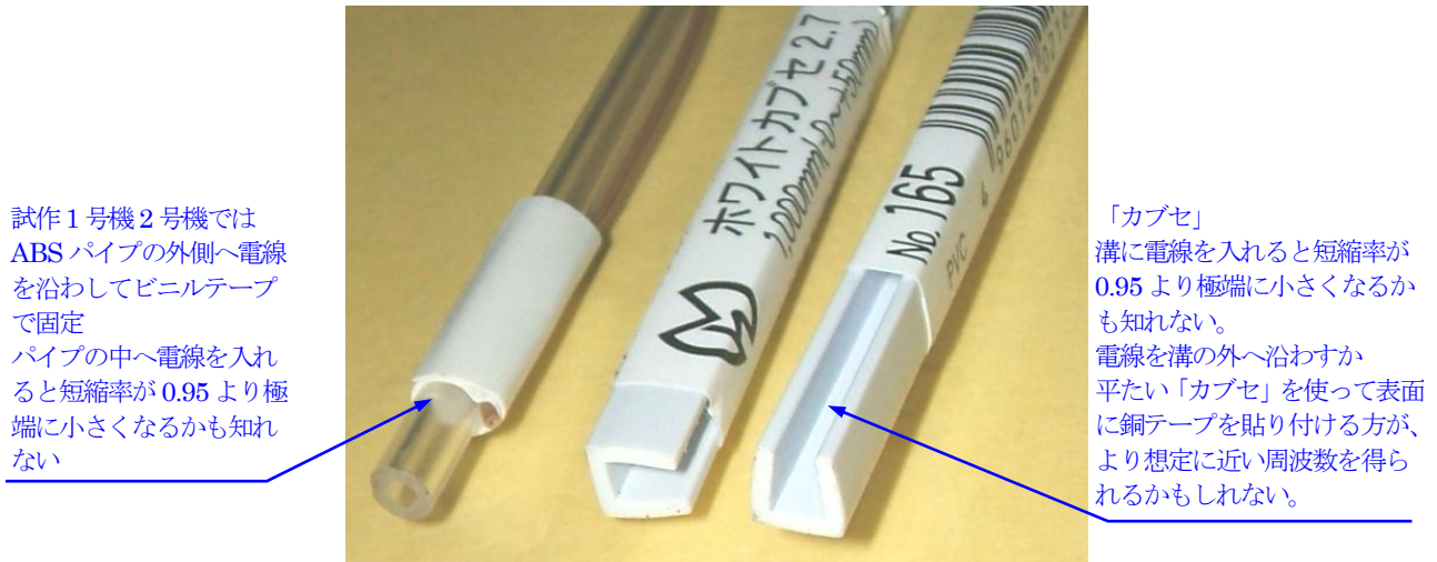
写真3 アンテナエレメントを支える材料
