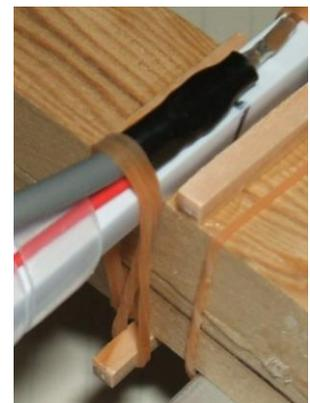
ダイポールアンテナを作ってアンテナの端子電圧がピークとなるエレメントの長さを確認する。
